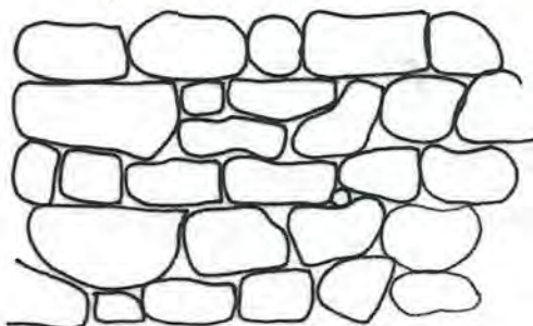
Mur en moellons vue de face
